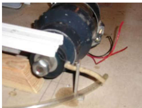
La came (en plexiglass) et son graissage (mèche de lampe à pétrole imbibée d'huile)
