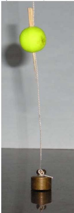
Ce corps mort est constitué par un masse marquée en laiton (2g), un bout de fil à coudre et un petit flotteur en mousse de polyuréthane (diamètre 8mm) réglable en hauteur à l'aide d'une petite clavette. Nous avons placé ce corps mort dans le bac à différents endroits et avons observé l'inclinaison du fil, et surtout les mouvements du flotteur. Il est apparu nettement que de l'eau était "recyclée" sur la cible ; de ce fait la quantité de mouvement est supérieure à ce qu'elle serait dans l'air.
