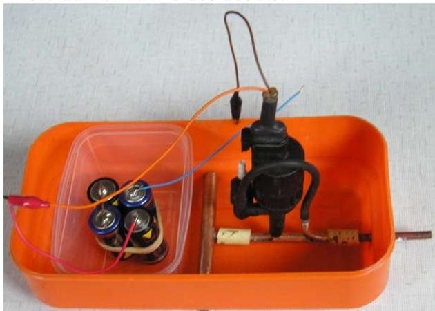
On distingue à gauche le compartiment des piles, dans le fond de la coque au milieu la traverse, en noir la pompe, et sur la droite la canalisation utilisée tantôt pour aspirer tantôt pour refouler.
