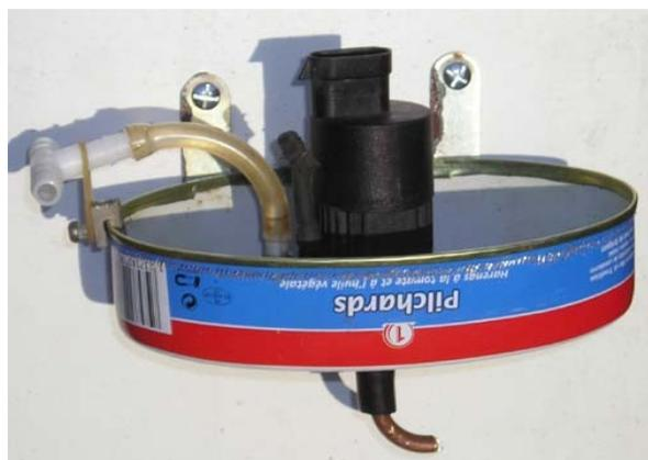
Tuyère d'aspiration sous la coque, bien dégagée du reste. Refoulement au-dessus de l'eau (de part et d'autre pour éviter les effets propulsifs indésirables).
