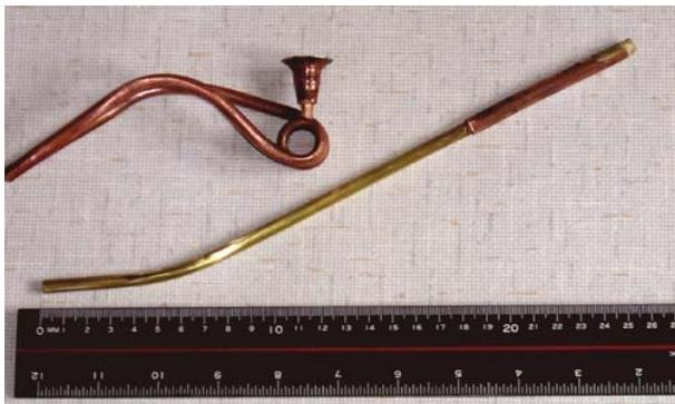
L'autre moteur est un modèle de simplicité. Il est fait avec un bout de cuivre de 8x1 (la partie chauffée) prolongé par un tube de laiton de 6x0,5. Ce moteur a marché pendant des heures.
