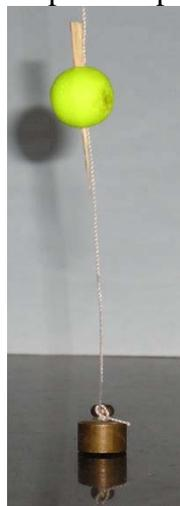
Ce corps-mort est constitué d'une masse (2g) reposant au fond du bac et d'un petit flotteur en polyuréthane maintenu à une distance réglable du fond par un petit fil à coudre et une clavette.
