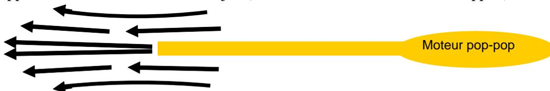
Dans la phase de relaxation une dépression se forme à l'extrémité de la tuyère. Pour combler ce "trou noir" l'eau arrive de toutes les directions.
