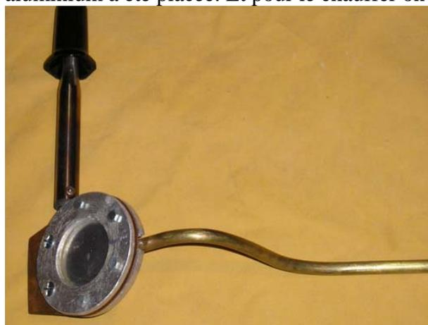
Une pièce d'adaptation spéciale (en cuivre) a été conçue pour transférer l'essentiel de la puissance électrique du fer à souder vers le moteur (en puissance de chauffe).
