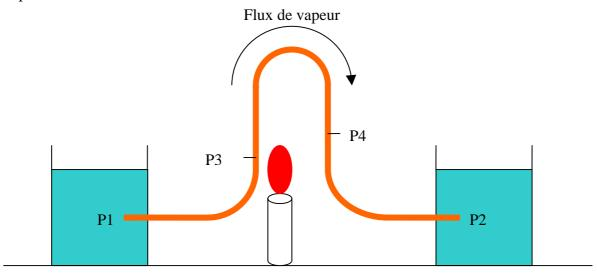
P1 et P2 sont les pressions statiques à la sortie des tuyaux.
