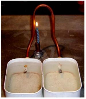
Le moteur (si on peut l'appeler ainsi) est symétrique. Les deux extrémités du tuyau sont raccordées à deux réservoirs adjacents.
