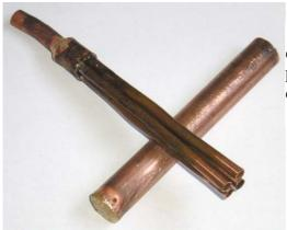
Sur un moteur à canalisation unique j'ai essayé un évaporateur muni de tuyaux à l'intérieur pour augmenter la surface de la source chaude. Rien de positif ou négatif à signaler.
