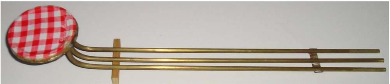
Le moteur pulse très bien. Par contre, je dois avouer que le côté auditif n'est pas à la hauteur des espérances. Quand on appuie le doigt au milieu du couvercle puis qu'on le relâche on entend bien le bruit caractéristique d'un tel couvercle. Mais en fonctionnement ce bruit est atténué. Pour un pop-pop sonore il vaut mieux utiliser une fine membrane.
