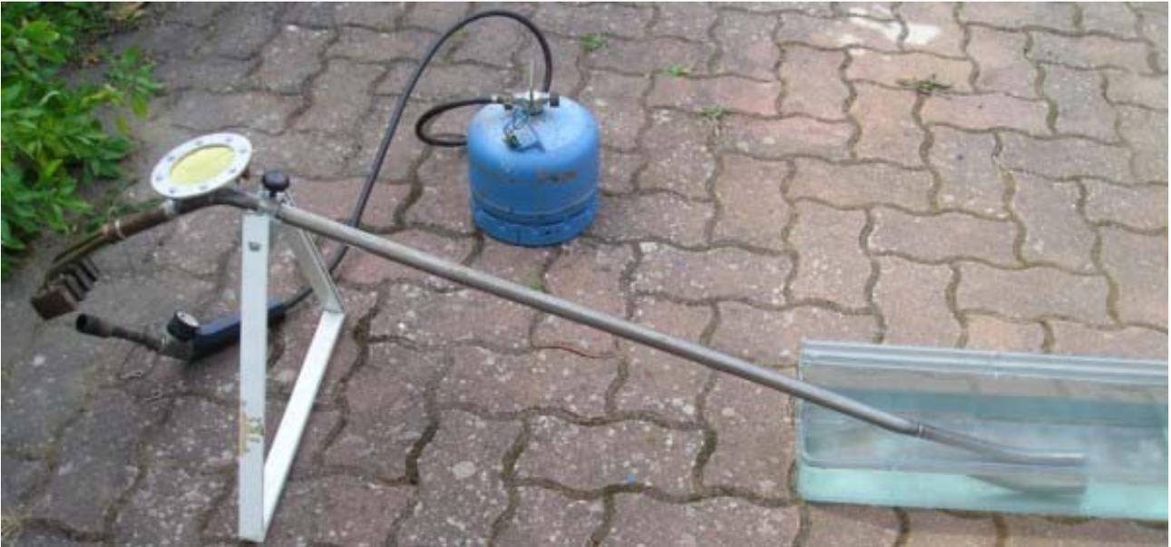
Après ces essais, un couvercle neuf prit sa place sur mon établi. Je viens enfin de me décider à en finir avec lui. Cette fois, au lieu de l'adapter sur un moteur existant j'ai fait un nouveau moteur. Grande chaudière (diamètre 86mm) et 3 tubes de diamètre intérieur 5mm. Ça marche!
