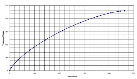
Tension efficace en fonction de la tension lue derrière un triac
