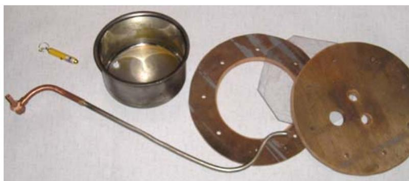
Nota : les coudes inférieurs du moteur ont été rendus nécessaires pour le raccorder au bol à la partie inférieure afin de permettre le passage de la bride inférieure (en contreplaqué) après finition des soudures.
