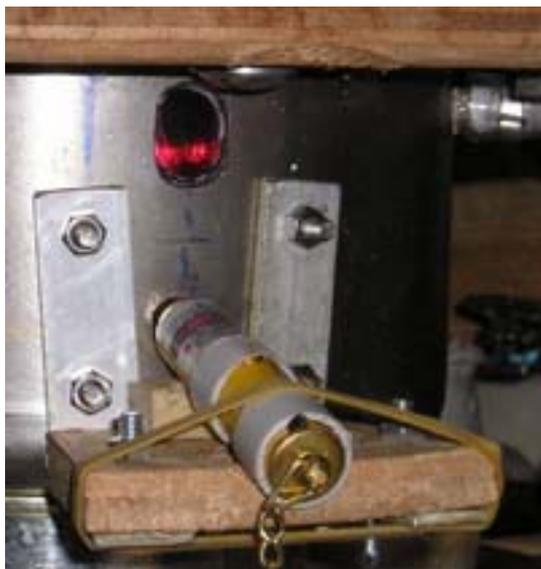
Pour la version suivante du banc d'essai j'ai dû utiliser un morceau de plexiglass que j'ai cintré comme le bol. En raison de cette déformation, le fin rayon laser envoyé par l'émetteur (un pointeur laser, jaune sur la photo) est devenu un faisceau plat (visible sur la fenêtre supérieure du bol).
