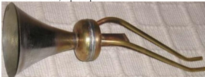
Pour le brûleur il a été utilisé le support de mèche d'une vieille lampe à pétrole. Avantage: la puissance de chauffe est réglable.
