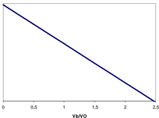
Pour un moteur pop-pop donné ( $v_0$  ou  $C$ ,  $F$  et  $d$  connus) on voit donc que la poussée décroît linéairement lorsque la vitesse du bateau augmente. On peut représenter la poussée sur un diagramme en fonction de  $V_b/v_0$ .
