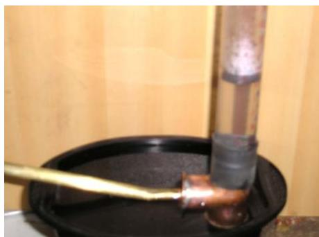
$14 \text{ g}$  pour un tuyau de  $26 \text{ cm}^3$ . On peut considérer –faut de mieux– que quand le moteur marche bien la masse d'eau en mouvement est environ la moitié de ce que peut contenir le tuyau dans sa partie descendante.
