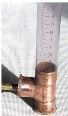
J'ai réutilisé un moteur connu avec chauffage électrique et je l'ai raccordé à un Té Sudo fermé dans le bas et sur le côté par des opercules soudés. Et sur le dessus j'ai raccordé une éprouvette de même diamètre à l'aide d'un bout de chambre à air de vélo.
