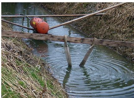
Notre moteur avait un ballon de quelques litres et un tube de 40mm de diamètre. Celui d'Eljoh et Jorn avait un ballon de 100 litres et un tube d'environ 55mm de diamètre.
