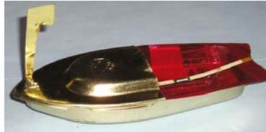
Le bateau allant à la vitesse  $V$ , de par le système de propulsion la vitesse de sortie de l'hydrojet est au moins une fois par cycle supérieure à  $V$ .  $v_{\max} > V$
